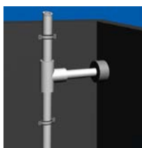
2. Соединение от стояка сквозь стену через отверстие
